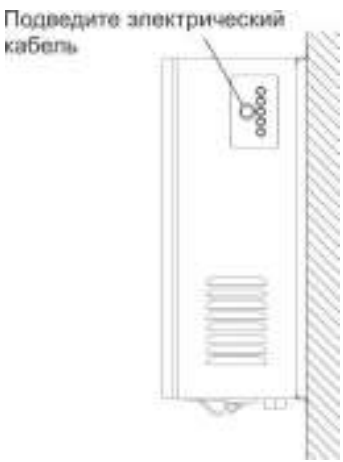
Рис. 7. Расположение панели вывода электрического кабеля
